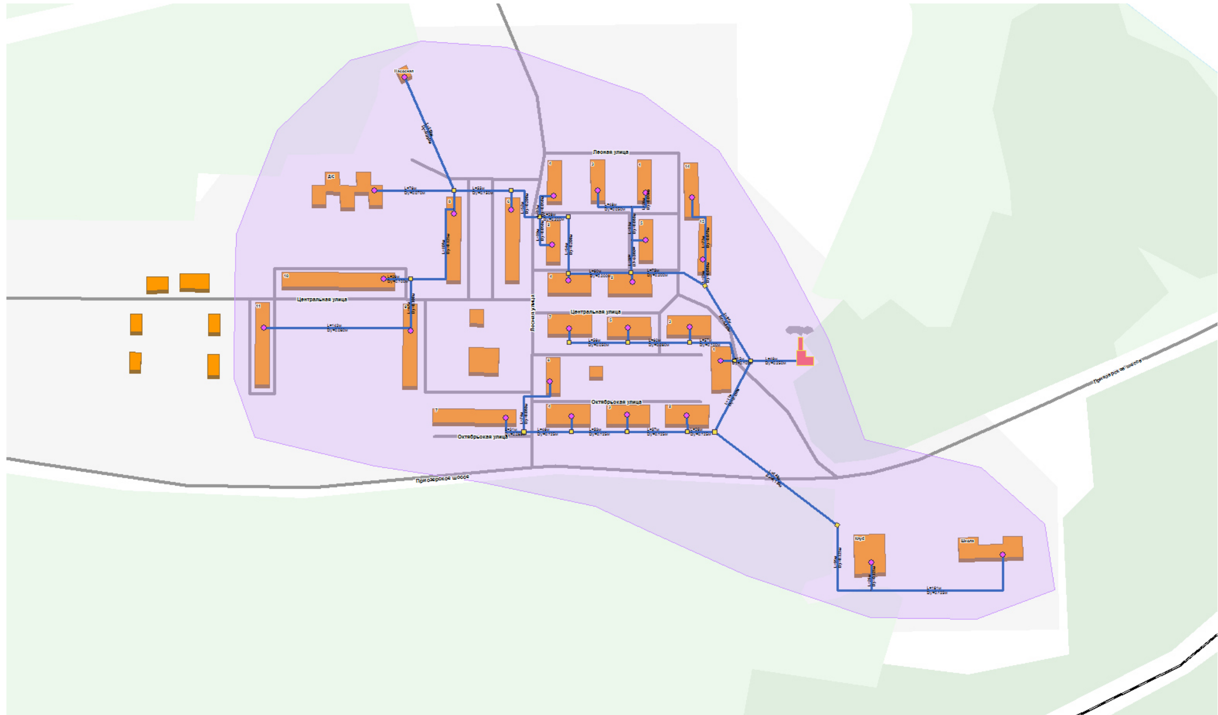
Рисунок 2.2.3. – Зона действия котельной в п. Суходолье
